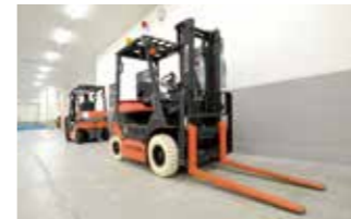
空気汚染防止対策として、排気ガスの出ない電動フォークリフトを導入
